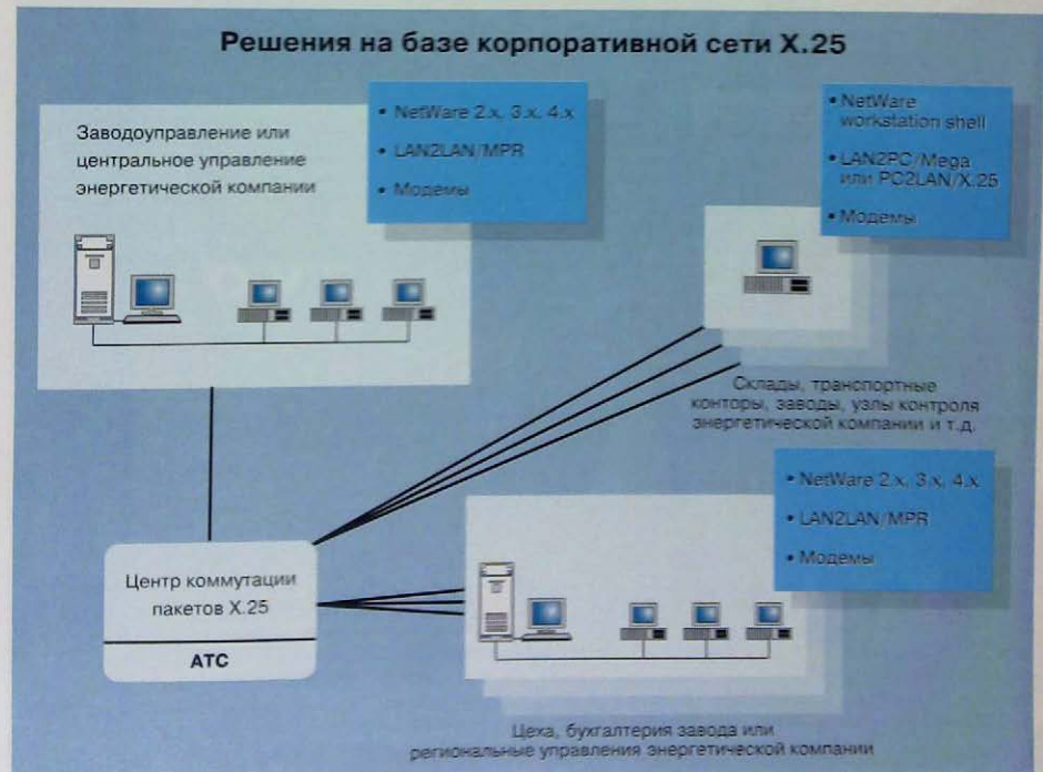
Рис. 1. Пример построения корпоративной сети для организаций, располагающих каналами связи.
