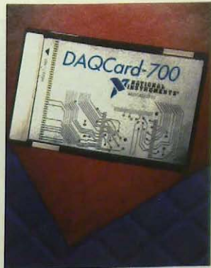
Рис. 3. PCMCIA-карточка сбора данных потребляет мало энергии, поэтому может работать в блокнотном ПК, питающемся от батарей.
