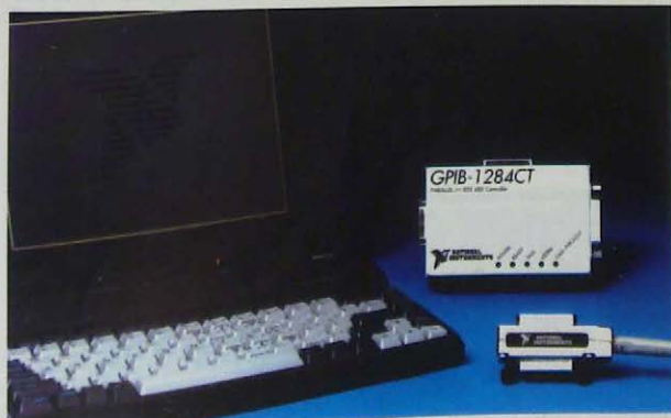
Рис. 2. Даже если в компьютере нет никаких интерфейсов, кроме параллельного порта, к нему можно подключить приборы с интерфейсом GPIB.
